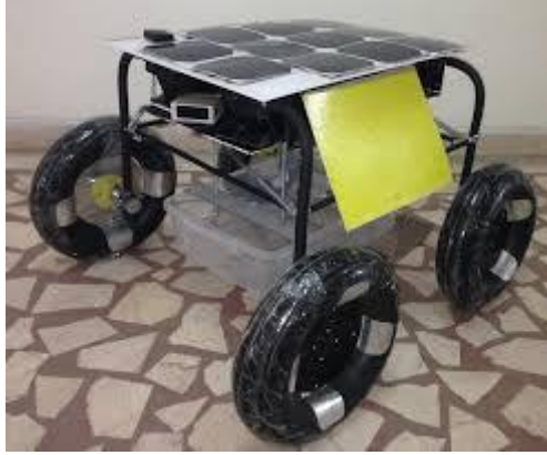
Şekil 6. Zararlı Böcekleri Yakalayan GPS ve Güneş Enerjisi İle Çalışabilen Zeki Tarımsal Robot
